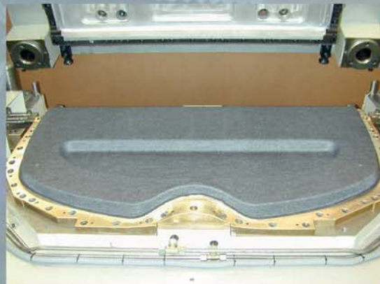
Stamping, pierce and trim die/Präge, Loch und Beschneidwerkzeug/ Troquel estampado, punzonado y corte
